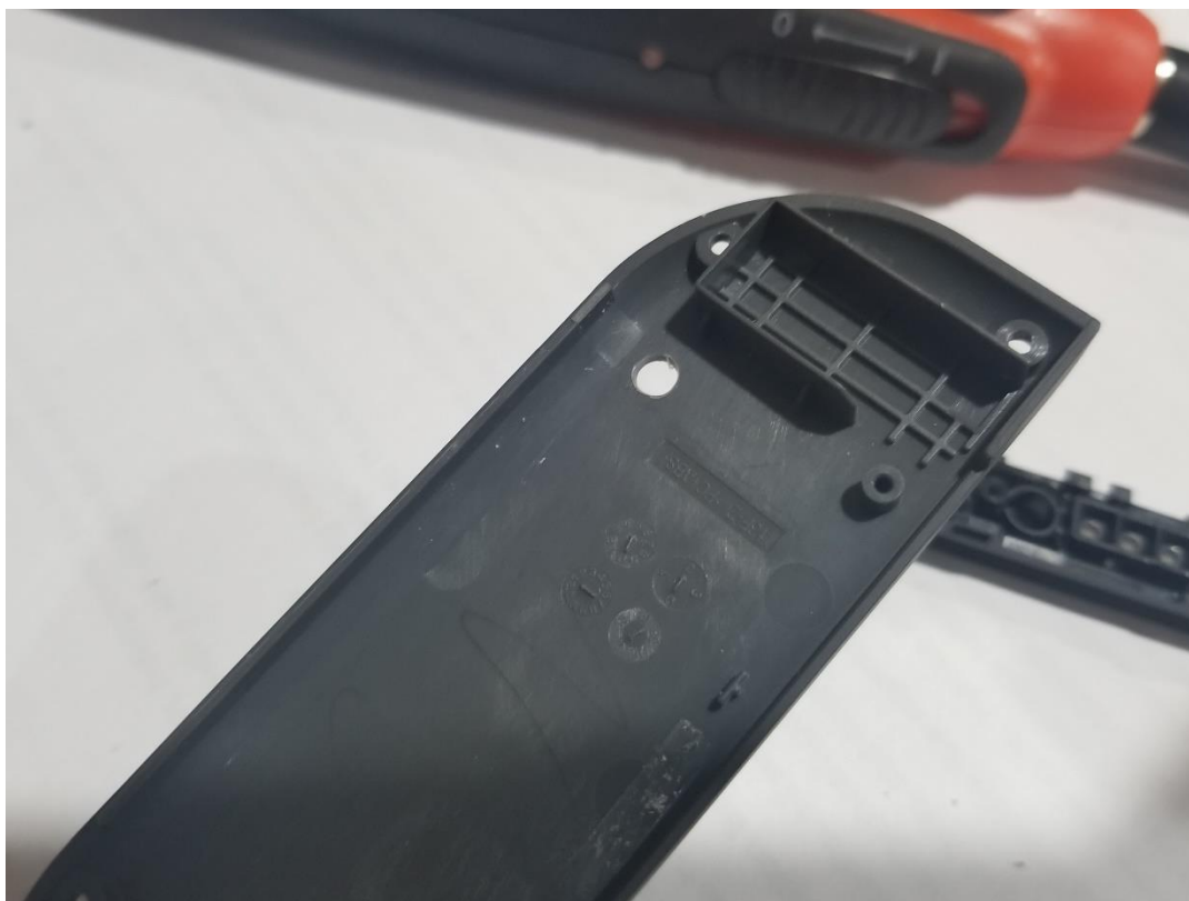
(Imatge 17 - Forat foradat a la part posterior del JoyCon (Massa a l'esquerra de la zona rectangular))
