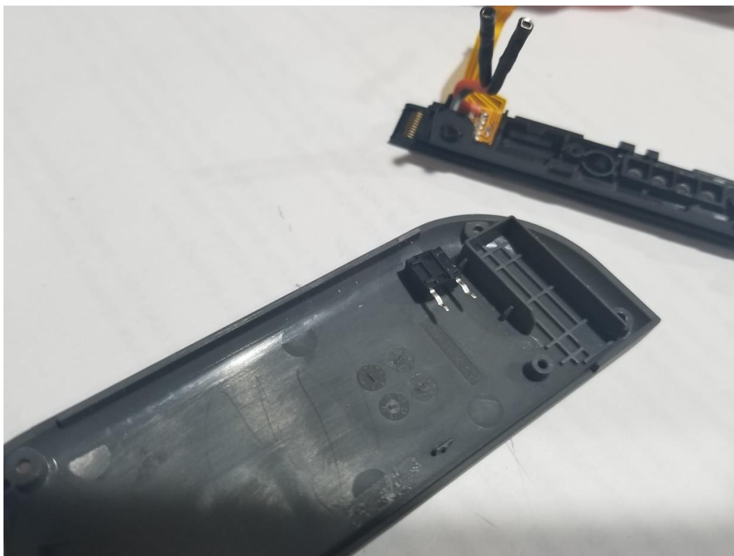
(Imaginea 16 – Potrivirea locului de găurit folosind întrerupătorul)
