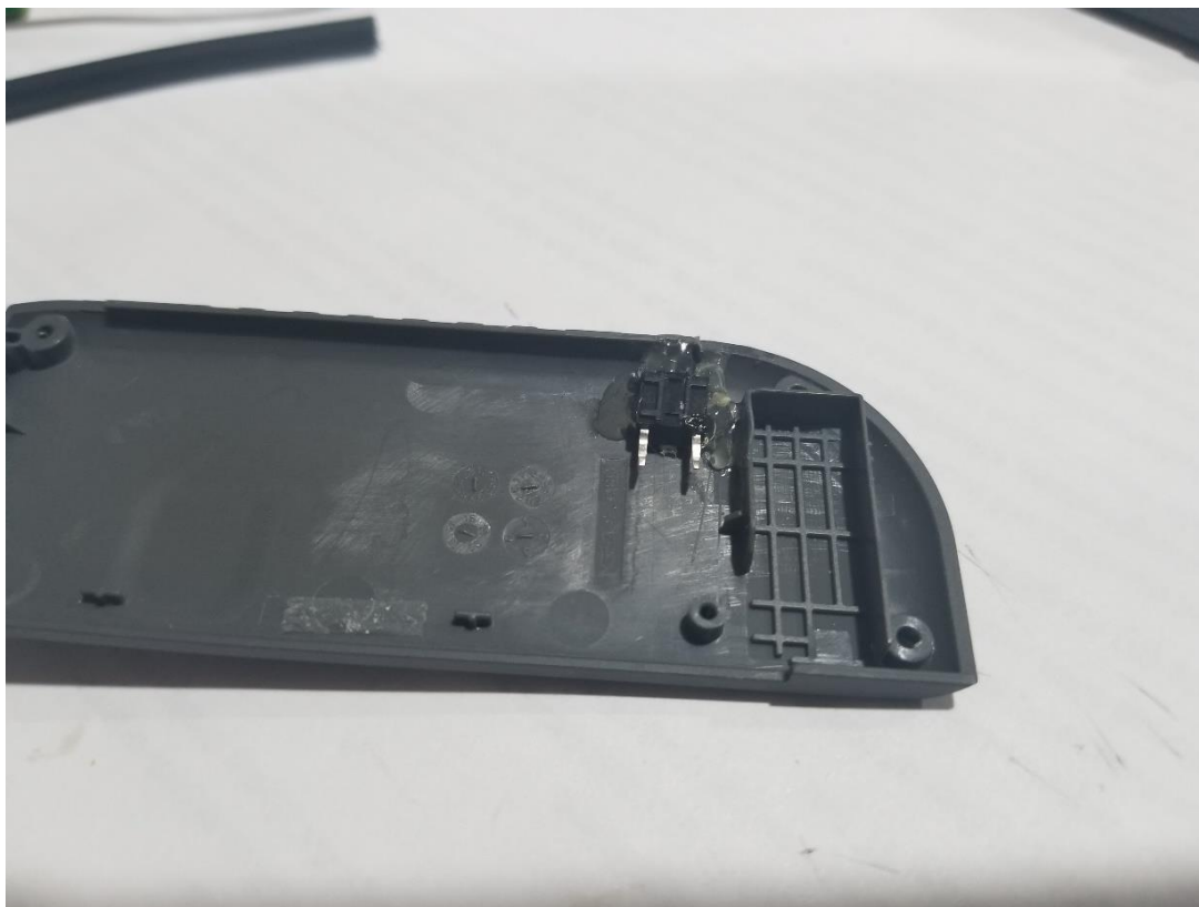
(Imaginea 18 - Întrerupătorul fixat cu plastic topit)
