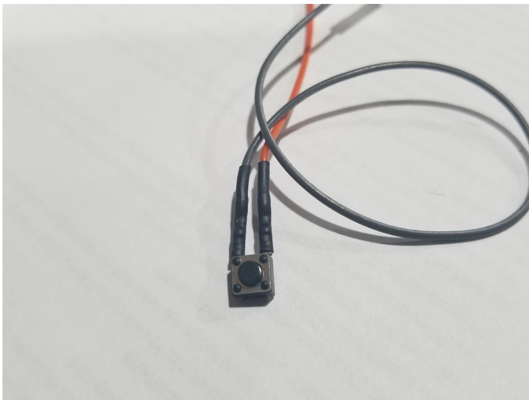
(Imaginea 13 - Întrerupătorul fără reținere conectat la fire)
