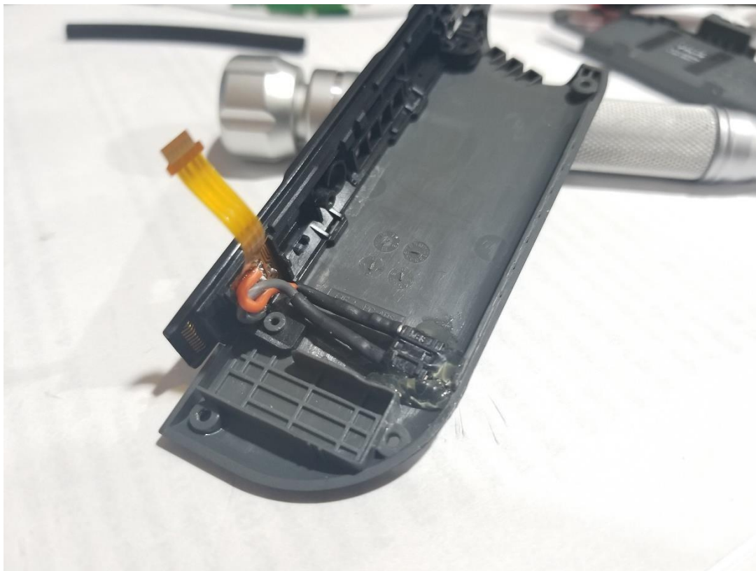
(Imaginea 24 - Conectorul culisant al JoyCon-ului conectat la întrerupător și la spatele JoyCon-ului)
