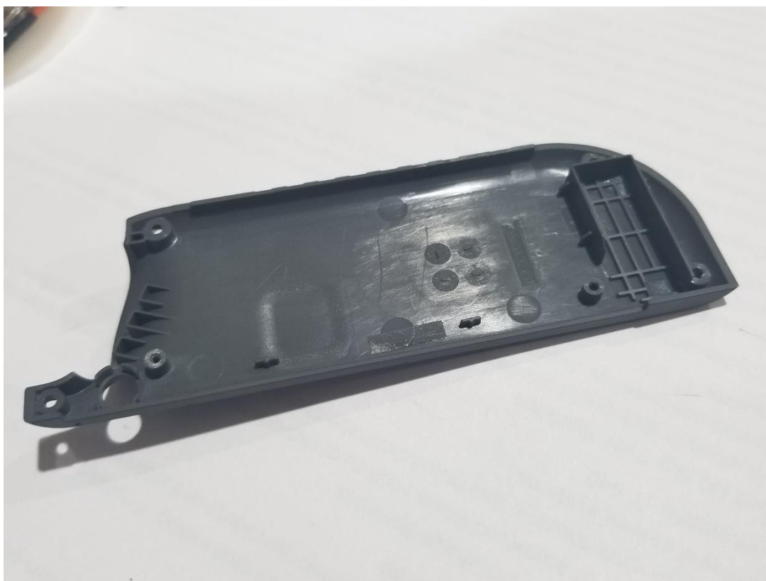
(Imaginea 14 – Capacul din spate înlăturat al JoyCon-ului)
