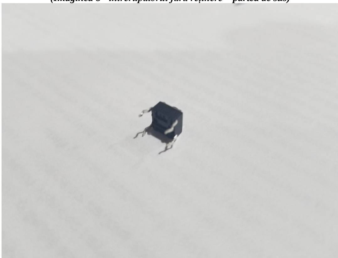
(Imaginea 9 - întrerupătorul fără reținere – Partea laterală și dosul)
