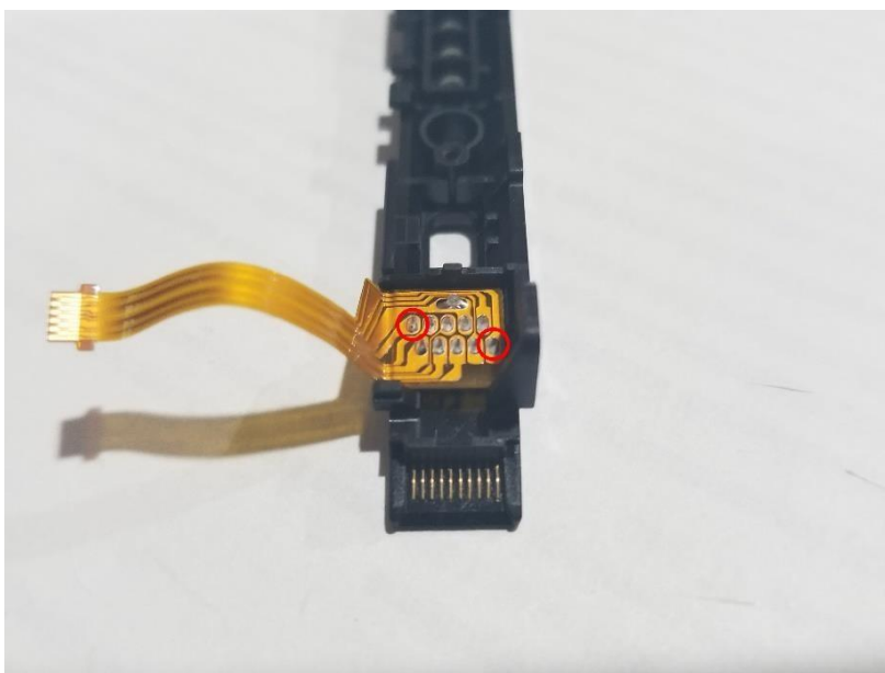
(Imaginea 21 Punctele de lipire pentru pinii 1 și 10 încercuiți cu roșu)
